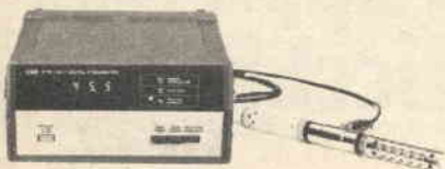
Igrometro e termometro nello stesso strumento.
